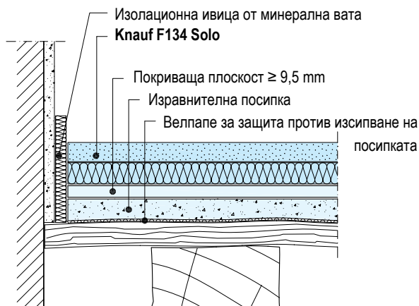
F134-V4 Изравняване на височината със суха посипка
